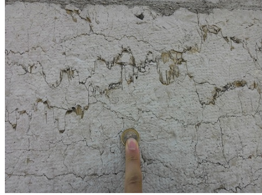
FIGURE 9 – Joints stylolithiques dans un calcaire du Malm.
